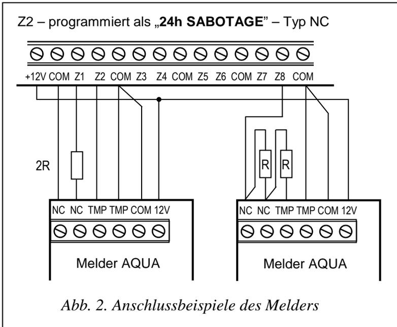
In Abbildung 2 sind typische Anschlussbeispiele der Melder in der parametrischen (EOL) und zweiparametrischen (2EOL) Konfiguration dargestellt. Der Widerstand wird im Gehäuseinneren montiert.
